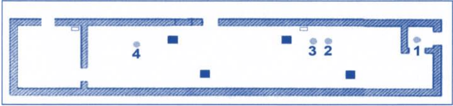
Abbildung 25: Leichenhalle des Krematoriums I, heutiger Zustand. Graue Kreise Nr. 1 bis 4: Lage der früheren kreisrunden Löcher, die jetzt ausgefüllt sind. Nr. 1 war das Zuluftloch der provisorischen Lüftungsanlage, heute in der Schleuse gelegen, siehe Abb. 18 & 24. Die Nr. 2 bis 4 wurden 1944 während des Umbaus dieses Gebäudes in einen Luftschutzbunker hinzugefügt (siehe Abbildung 26a-c). Schwarze Quadrate: die vom Museum erstellten Zyklon-B-Schächte; leere Rechtecke: Backstein-Lüftungsschächte des Luftschutzbunkers, immer noch vorhanden, siehe Abbildung 14.
