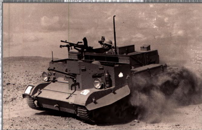
Ein britischer Bren-Gun-Carrier 1940 in Ägypten. Fahrer und Kommandant nahmen im Gefecht hinter den vorderen Panzerplatten Deckung, aber der Schützenpanzer war offen und leicht mit Handgranaten zu bekämpfen. Der Bren-MG-Schütze im hinteren Teil war am schlechtesten geschützt.
