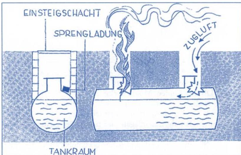
Die Sprengung wird immer ausserhalb des Tankraumes angebracht. Es werden immer beide Tanköffnungen gesprengt, so dass im Tankinneren Durchzug entsteht.
