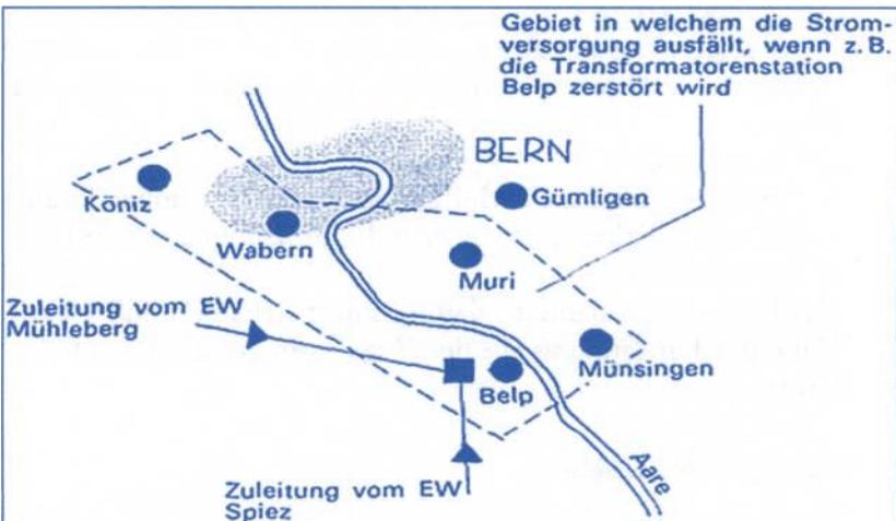
Gebiet, in welchem die Stromversorgung ausfällt, wenn z.B. die Transformatorstation Belp zerstört wird.
