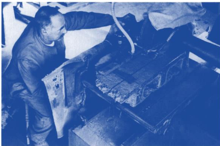
Grossvater Johann Hug an der Betonprüfmaschine. Eidgenössische Materialprüfungsanstalt (EMPA) Anfang der Dreissigerjahre.
