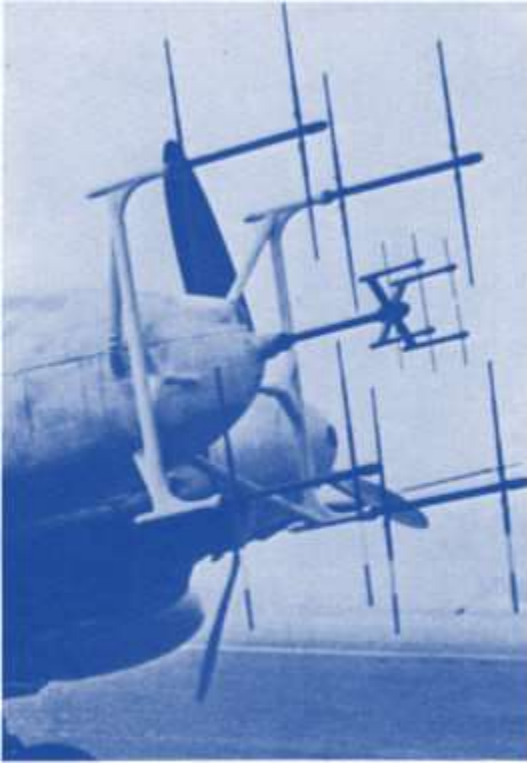
Die Hirschgeweih-Antenne der FuG-202- und FuG-220-Funkmessgeräte (Radar) der Me 110G-4C9 + EN
