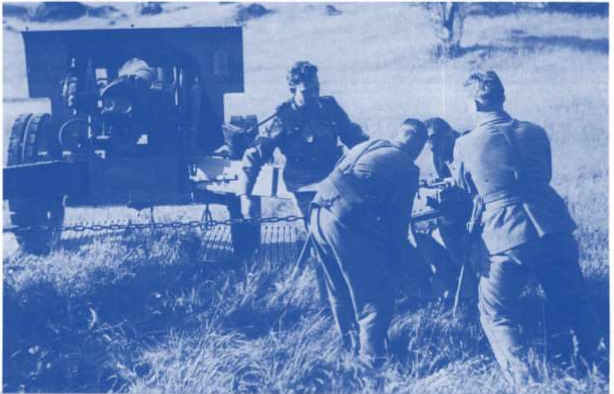
10,5-cm-Kanone: Das unter 2 Tonnen liegende Gewicht ermöglicht es, sie als Feldartillerie im Rahmen der Division zu verwenden
