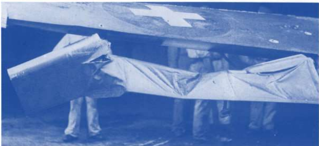
14. Juni 1940: Bei der Wartung beschädigte Morane-Saulnier M.S.406 (Mo 3800)
