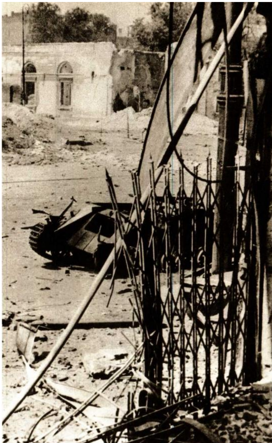
Die ferngelenkten «Goliath» kamen in 2 Versionen zum Ein- satz: mit Ottomotor (Reichweite 1'000 m) oder Elektromotor (Reichweite 600 m)
