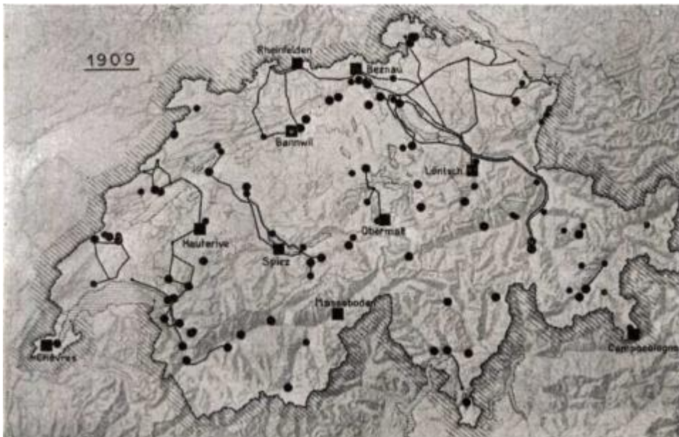
Wasserkraftwerke der Schweiz und ihre Verbindungsleitungen. Stand Ende 1909.
