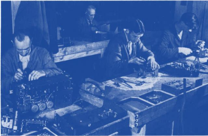
95 Gleich nach dem Krieg werden ausgediente deutsche und amerikanische Funkgeräte «ausgeschlachtet» und zu neuen zusammengebastelt.
