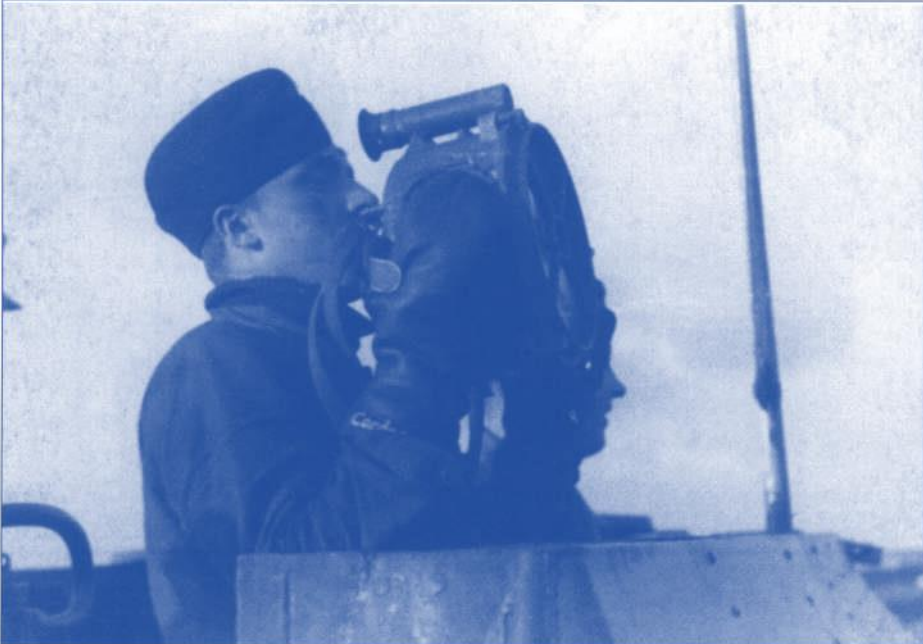
Brückenposten Cordes auf dem Turm von U 995 beim Morsen mit der «Klappbuchs», dem am Bordnetz angeschlossenen Handscheinwerfer.
