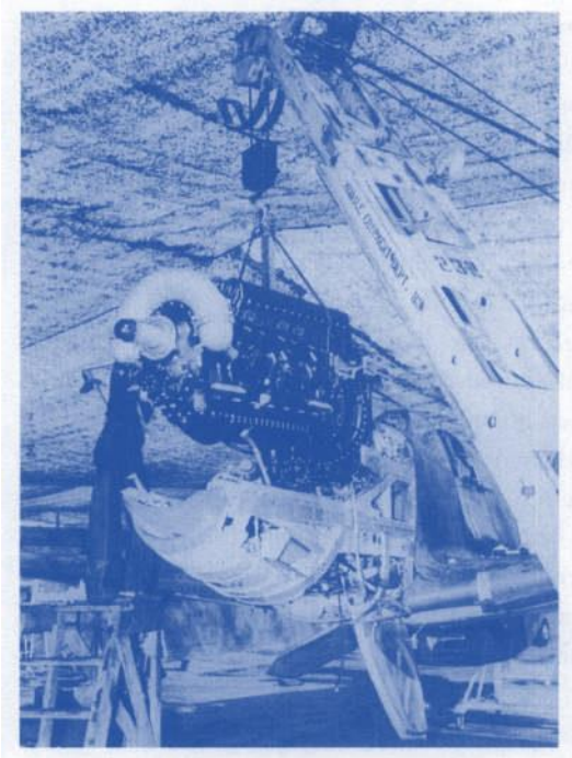
Perfekte Symbiose: Ein Merlin-Motor wird in den Rumpf einer P-51 Mu- stang eingebaut.
