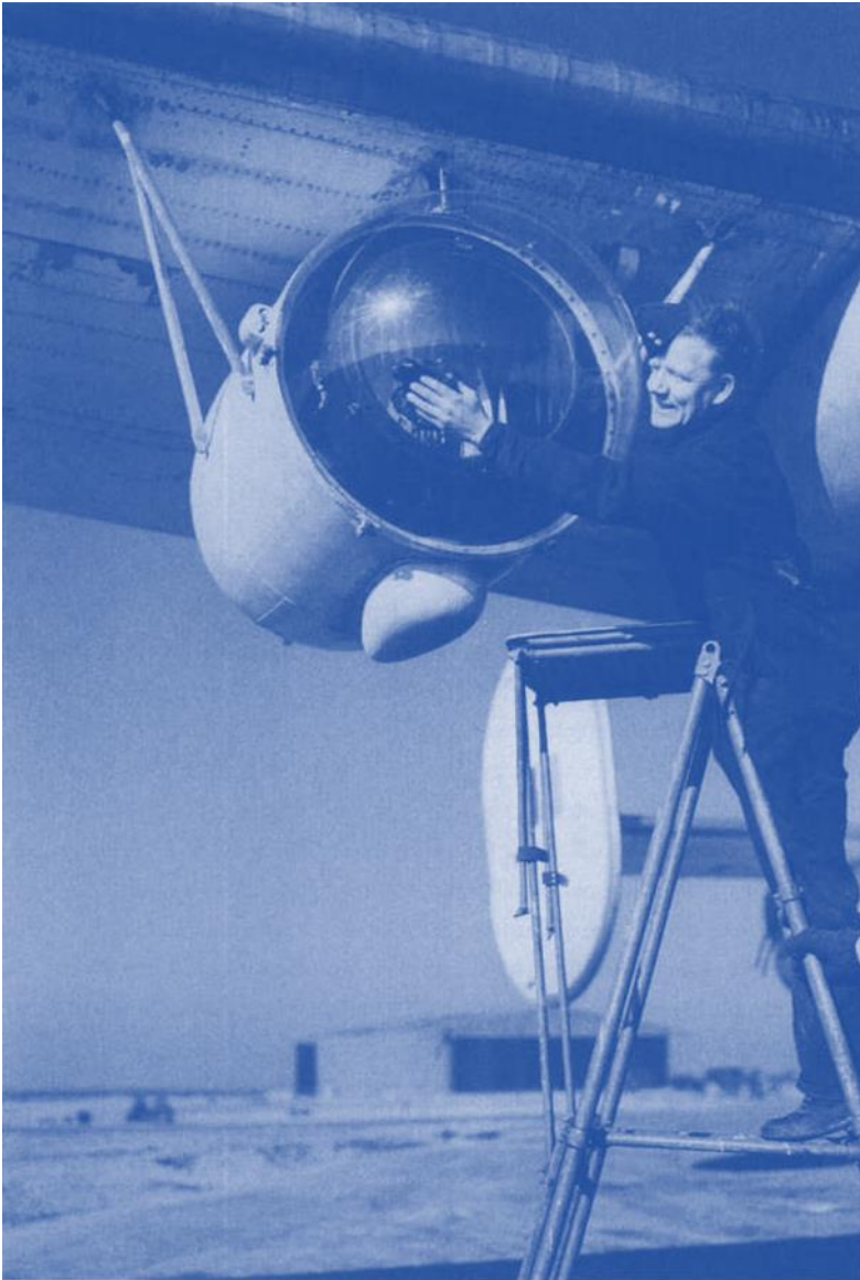
Es ward Licht: Der Leigh-Scheinwerfer am Flügel einer B-24 Liberator des RAF Küstenkommandos.
