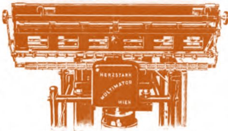
Herzstark-Multimator (Herzstark-Multimator) mit „ASTRA“ Schnelladdier- und Söldiermaschine (Herzstark-Multimator) mit „ASTRA“ Schnelladdier- und Söldiermaschine
