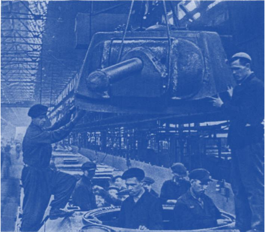
Leningrader arbeiten für die Front. Im Kirow-Werk wird ein Panzerturm eingebaut. 1942
