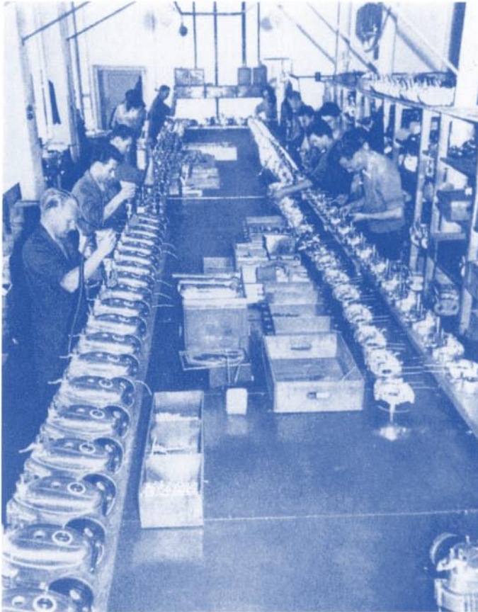
Abb. 200: Motormontage am Fließband in den Halleiner Motorenwerken
