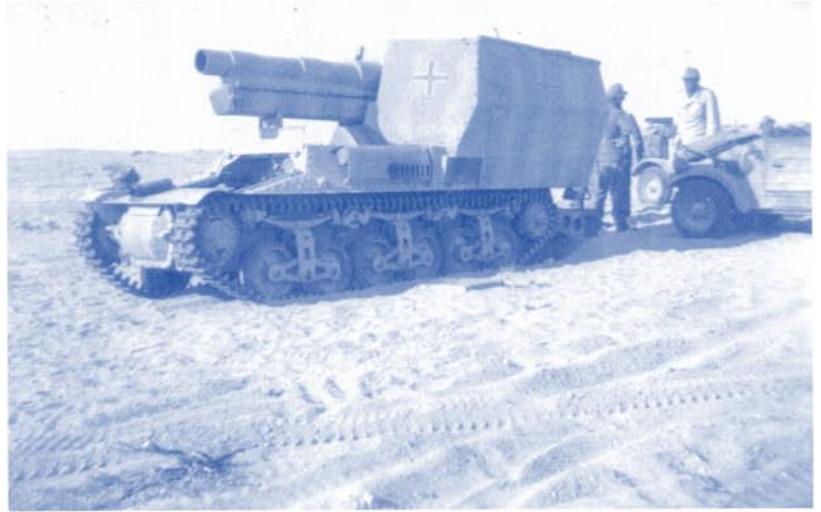
Eine der seltenen 15cm SFL auf Lorraine- Schlepper-Basis (Sd.Kfa. 135/1). Dahinter steht Ofw. Helms.
