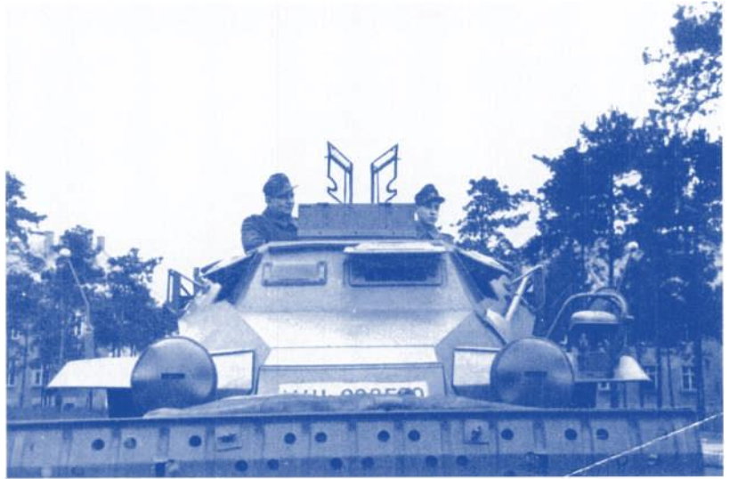
Leichter 4-Rad Panzer- spähwagen mit Sandblech an der Vorderfront.
