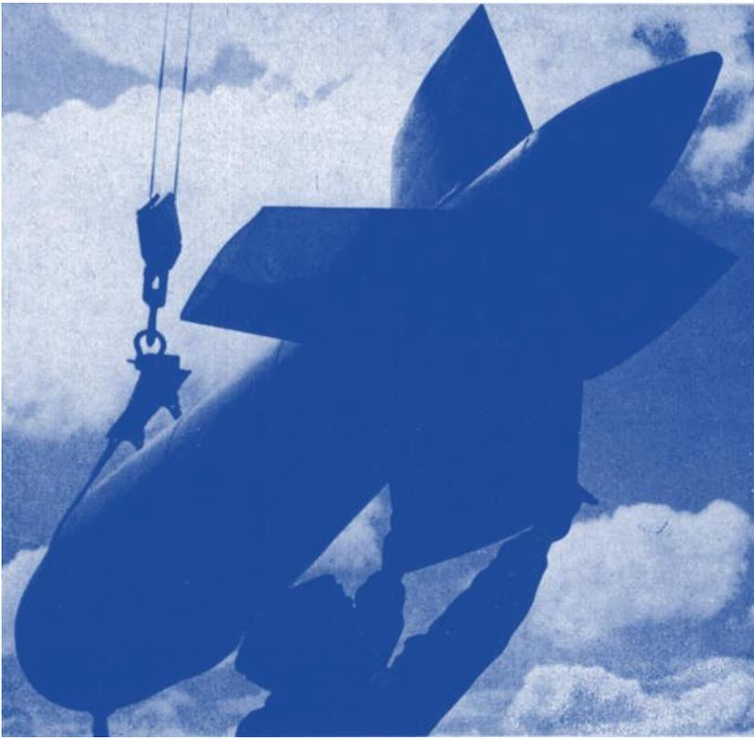
*Oben* Eine 5'500-kg-Bombe, genannt Tallboy, eine Schöpfung des Vickers-Armstrong-Konstrukteurs Barnes Wallis. Aufgrund des Kreuzleitwerks und der stromlinienförmigen Auslegung hielt die Kreiselwirkung die Superbombe beim Sturz durch die Schallmauer völlig stabil. Diese Bombe wurde ausschliesslich von Lancaster geschleppt und erstmals von der 617. Staffel bei einem Angriff auf den Eisenbahntunnel von Saumur in der Nacht vom 8. zum 9. Juni 1944 abgeworfen.
