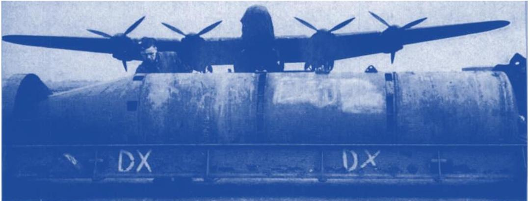
*Oben* Eine 5,5-t-Hochleistungsbombe vor einer Lancaster der 57. Staffel. Diese Bombe bestand aus drei Hauptteilen und einem Leitwerk und wurde zum erstenmal in der Nacht vom 15. zum 16. September 1943 durch Lancaster der 617. Staffel bei einem Tiefangriff auf den Dortmund-Ems-Kanal eingesetzt, wobei fünf von acht Maschinen verloren gingen.
