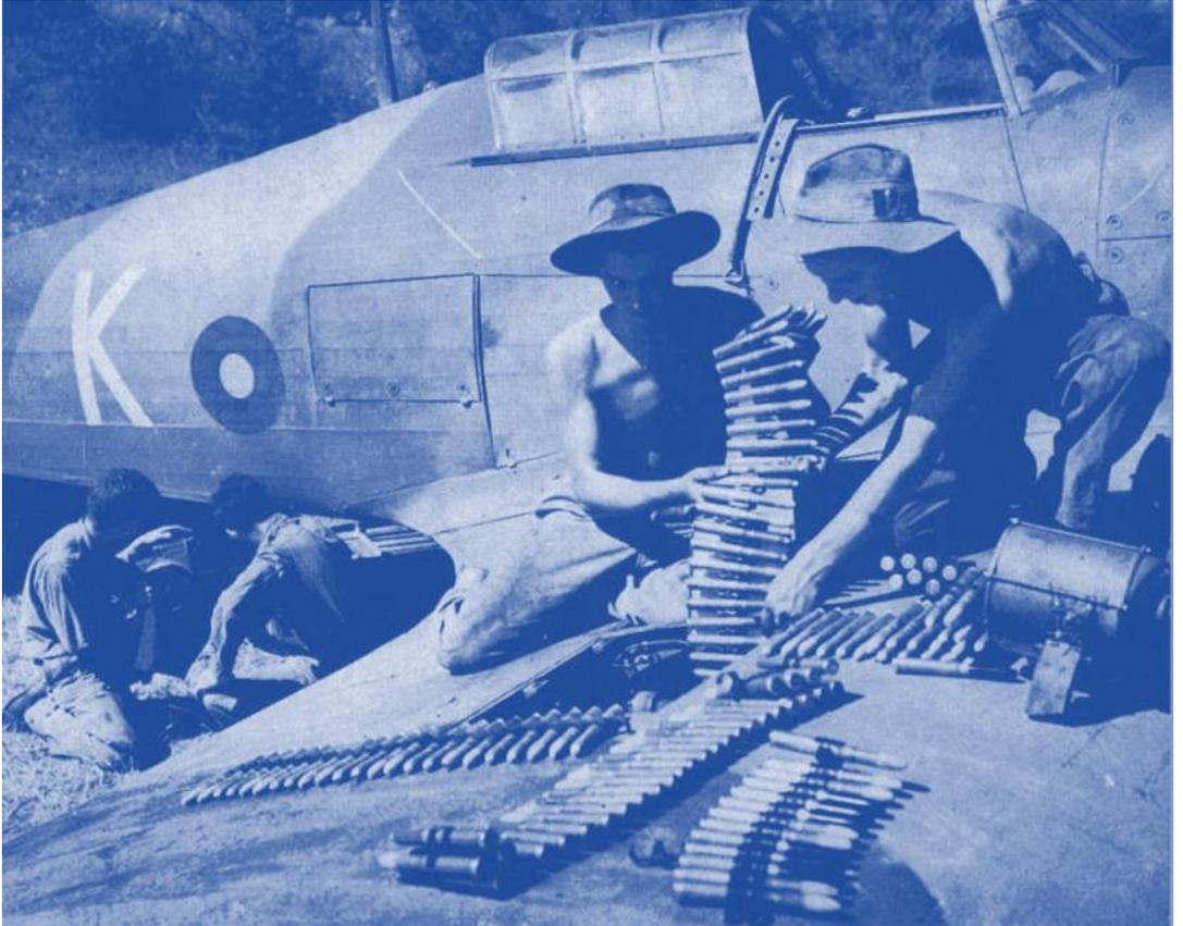
In Birma wird Anfang 1945 eine Hurricane zur bewaffneten Aufklärung fertiggemacht. Die 20-mm-Kanone wird gegurtet. Im Hintergrund wird eine Kamera eingebaut.
