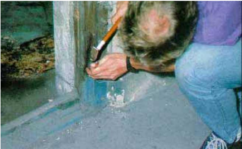
Abbildung 66: Aufnahme des Türpfostens aus dem Entwesungstrakt des Bauwerkes BW 5a, dessen unteres, rostiges Scharnier mit Blausäure Eisenblau gebildet hat. Entnahmestelle der Probe Nr. 18.
