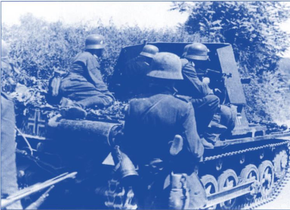
Links: Dieses vermutlich 1940 während des Frankreichfeldzuges aufgenommene Foto zeigt den ersten Jagdpanzer der Panzerwaffe, den Panzerjäger I auf dem Fahrgestell eines Pz.Kpfw. I. Ausf. B. Das Fahrgestell wurde umgebaut, um die Kanone aufnehmen zu können. Dieses Fahrzeug wurde mit einer tschechischen 4,7-cm-Pak ausgerüstet. Der Aufbau für diese Waffe war auf drei Seiten durch Panzerplatten geschützt und bot einen begrenzten Schwenkbereich von 15 Grad. Insgesamt 86 Schuss Munition konnten verstaut werden, die Besatzung bestand aus drei Mann. Die Kanone blieb bis 1942 in Dienst.
