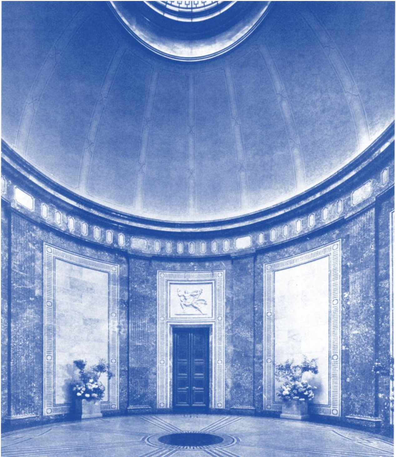
Der Runde Saal mit der Tür zur Marmorgalerie. Durch diesen «Scharnierraum» wurde der Knick in der Achse der Vossstrasse, den der Neubau zwangsläufig nachvollziehen musste, kaschiert.
