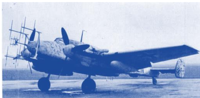
22. Die Messerschmitt Me 110, das «Arbeitspferd» der deutschen Nachtjäger. Mit dem Lichtenstein SN-2-Funkmessgerät am Bug der Maschinen orteten die Besatzungen die anfliegenden feindlichen Bomber.
