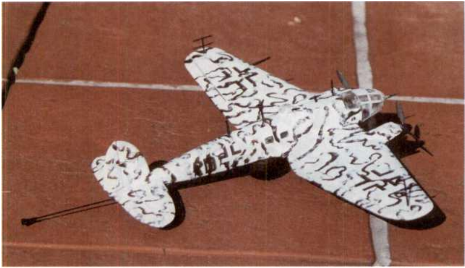
Heinkel-He-III-H-20-Flugkörperlenkflugzeug für Fi-103 (V-1) mit «Berlin»-Radar, Schleppantenne und Leitstrahlanlage (Antwerpen, 1944/45). (Modell Georg)
