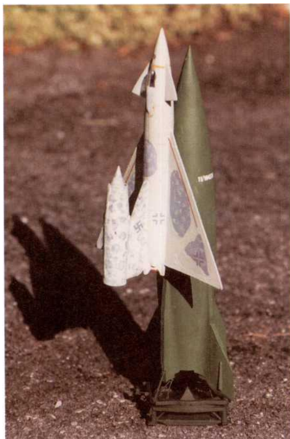
Projekt «Ross und Reiter»: En- tenflügel-A-9p mit Staustrahl- triebwerk auf A-10- Startstufe. (Modell Georg)
