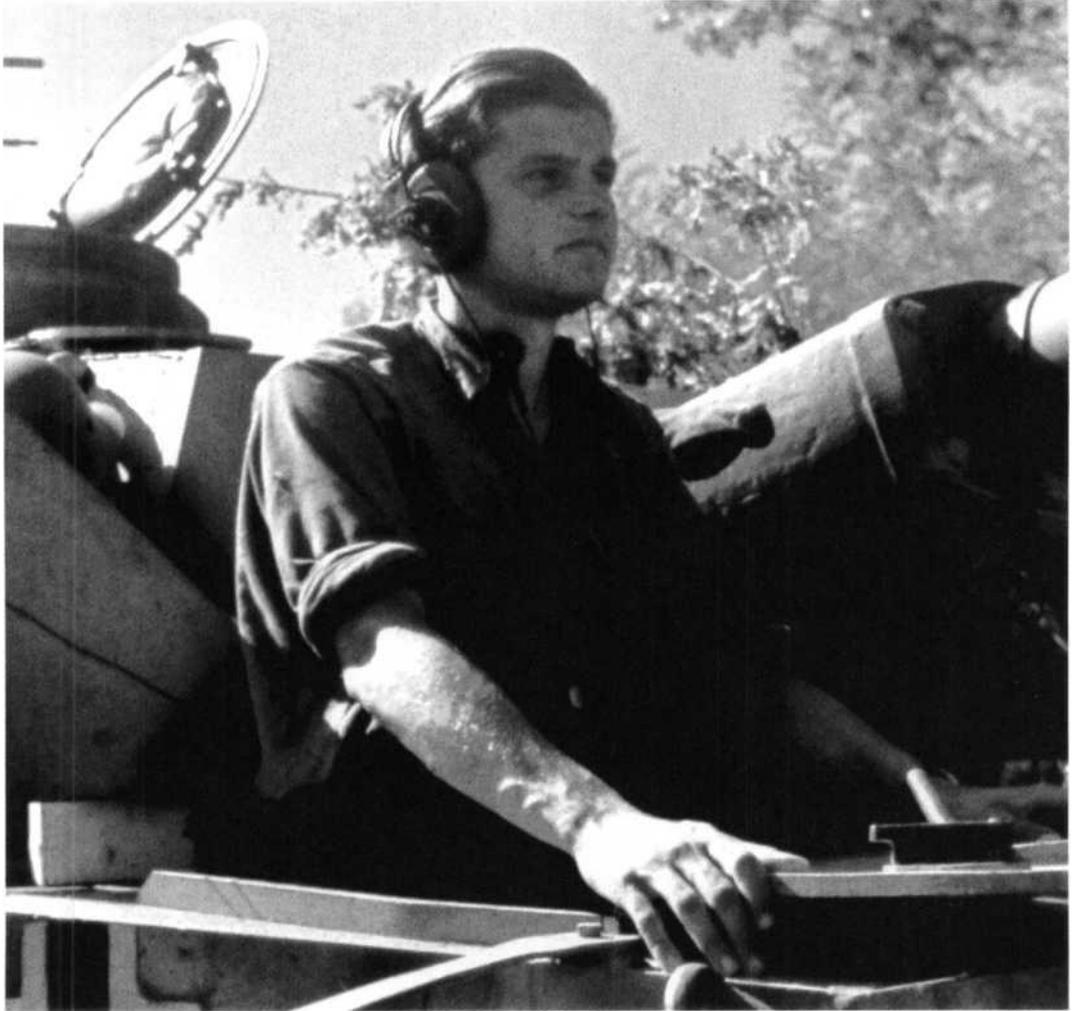
**Was wird der Tag bringen?** Skeptisch schaut der Funker mit Kopfhören und Kehlkopfmikrofon aus seiner Luke im Panzer IV. Der Deckel der Einstiegs Luke ist nach vorne aufgeklappt. Die Zusatzpanzerung verdeckt weitgehend das Balkenkreuz. Im Hintergrund ist der ledergepolsterte Deckel für die Kommandantenkuppel zu erkennen.
