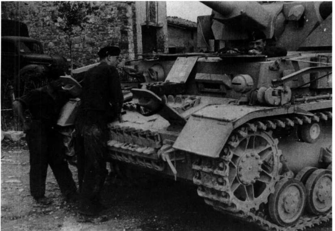
Zu schnell gefahren und heftig gebremst: Der Instandsetzungstrupp muss die Lenkbremsen reparieren, hierfür sind die Bremsklappen geöffnet.
