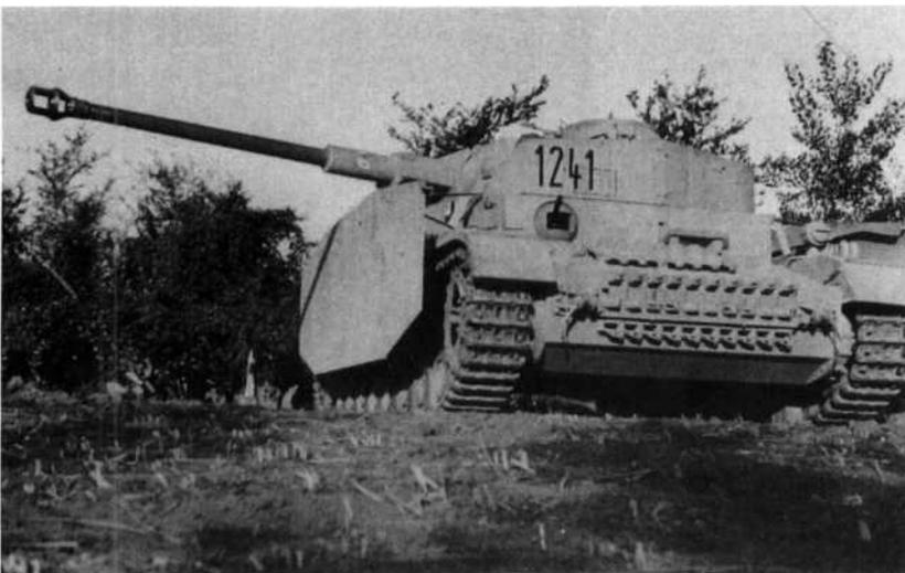
**Turmdrehen für ein Foto:** Pz. 1241 mit Turmstellung auf drei Uhr demonstriert geballte Kraft. Zusätzliche Schützenpanzerbleche sind am Turm angebracht, hingen an der Seite abnehmbar in einem Metallgestell eingehängt.
