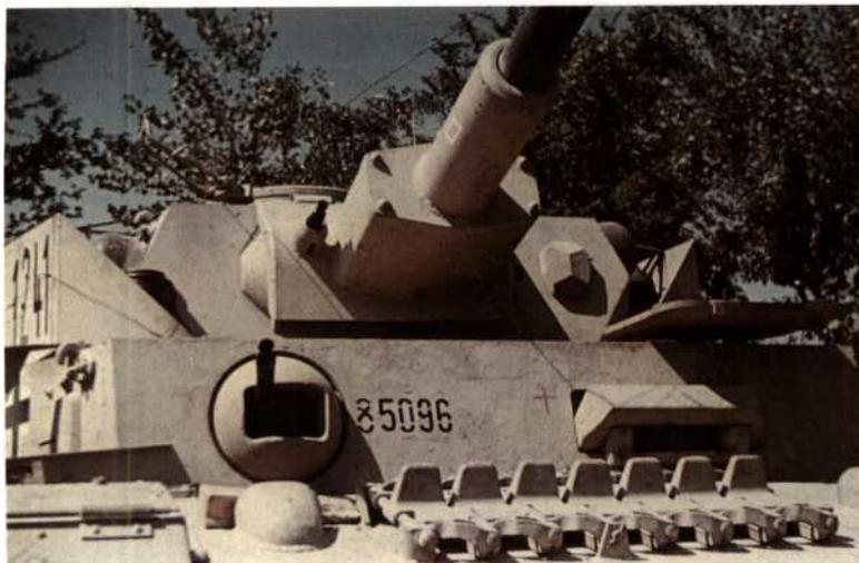
**Vorbild für eine japanische Publikation:** Blick auf Panzerkastenoberseite und Turm zur Stirnwand ist links die Kugelblende des Funker-MG34. Rechts Fahrersehklappe. Am Turm neben der Walzenblende rechts die (geschlossene) Sehklappe des Richtschützen. Links das MG. Deutlich die Fahrgestellnummer.
