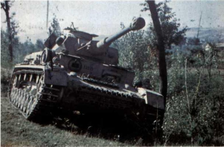
**Panzer IV (Ausf. G) ohne Schürze:** Am Bugpanzer sind zusätzliche Kettenglieder befestigt. An der Stirnwand links die Kugelblende mit MG 34 des Funkers. Die Lampen auf den Abdeckblechen haben Schlitzblenden.
