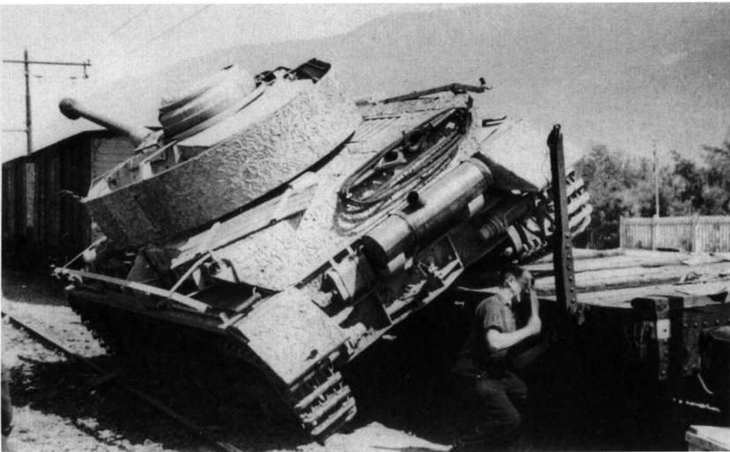
**Missgeschick eines Panzerfahrers:** Nach dem Austausch eines Eisenbahnwaggons mit heissgelaufener Achse hat der Fahrer «gepennt»: Durch zu hartes Anziehen des Bremsknüppels ist ein Panzer beim Verladen vom Transportwagen gerutscht. Deutlich ist der Zimmeritanstrich gegen Hafthohlladungen von Panzernahkämpfern am Panzer zu erkennen.
