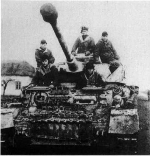
**Panzer 1244 auf seiner letzten Fahrt am 3.02.1944 im Brückenkopf Nikopol:** Deutlich sind die Spuren der Einsätze zu erkennen. Schürze und Panzerkette am Bug sind verlorengegangen, Schwarzerde und Schlamm auf dem Panzer.
