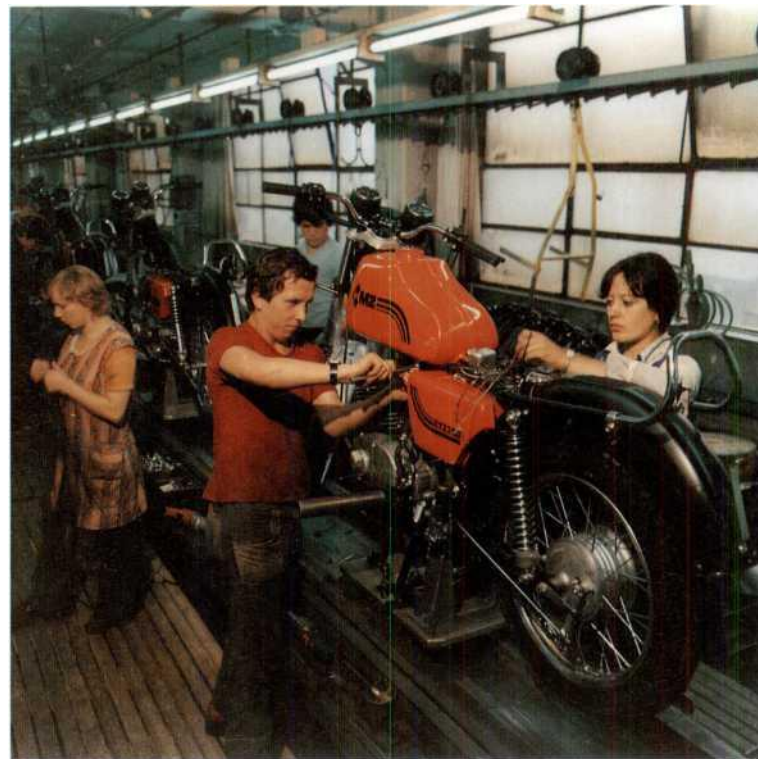
Ohne die Frauen stünden manche Montagebänder still – Arbeiterinnen bei der Elektroinstallation in einem FEB Motorradwerk
