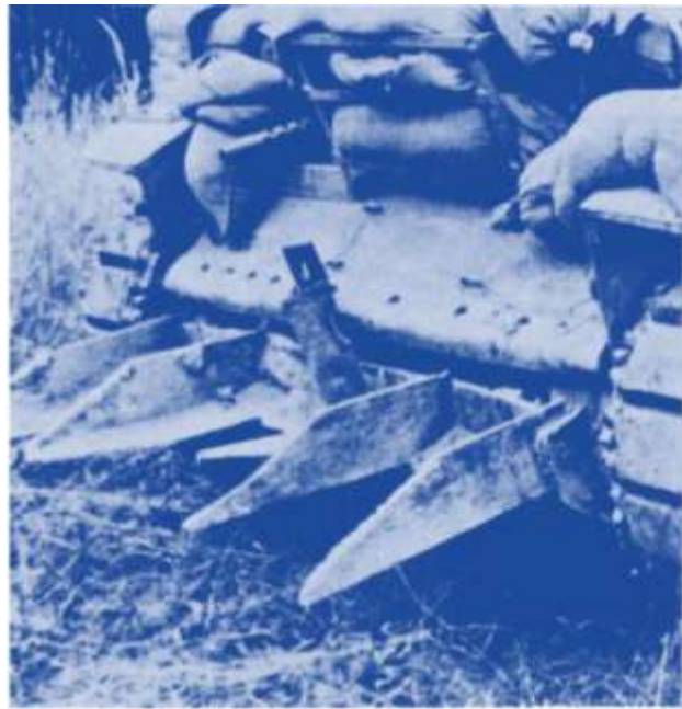
«Rhinoceros» mit Heckenschneide-Vorrichtung: aus Teilen deutscher Strandsperren angefertigt – eine Waffe gegen die unüberwindlichen Bocages
