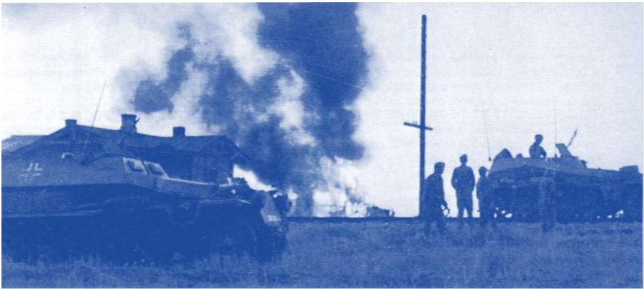
Marschkurs einer Vorausabteilung; linksin mittlerer Schützenpanzer Sd Kfz 251, rechts ein leichter Schützenpanzer Sd Kfz 250
