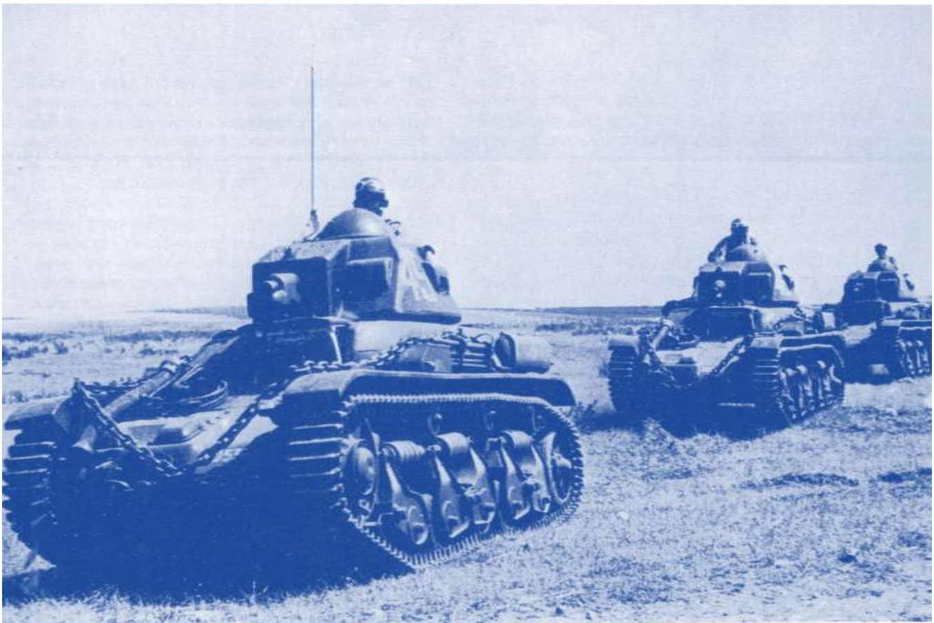
April 1940, Frankreich: Leichte Kampfpanzer vom Typ Renault R-35 mit einer 3,7-cm-Kanone und einem 7,5-mm-MG
