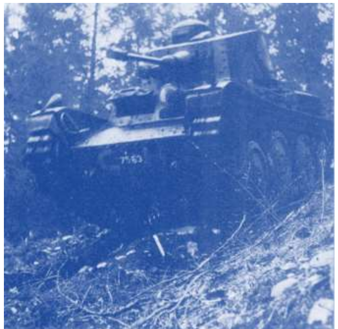
Oben: Tschechischer Panzer vom Typ Kw Danek Praga (LTL-H) im Dienst der Schweizer Armee beim Manöver in der Gegend von Thun
