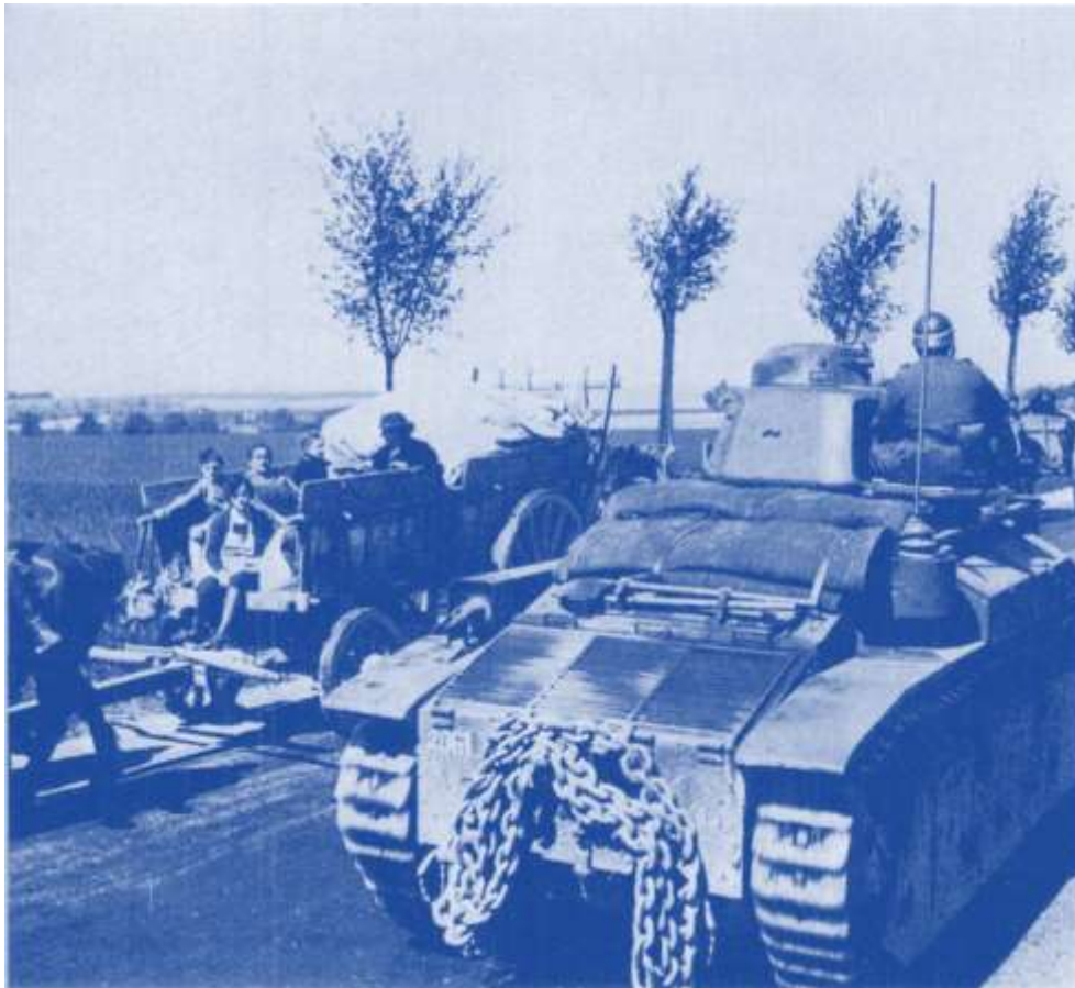
15.5.1940, bei Le Havre: Eine Kolonne von Panzern R-35 auf dem Weg zur Front. Die Luke im Turmheck dient geöffnet als Sitz für den Kommandanten
