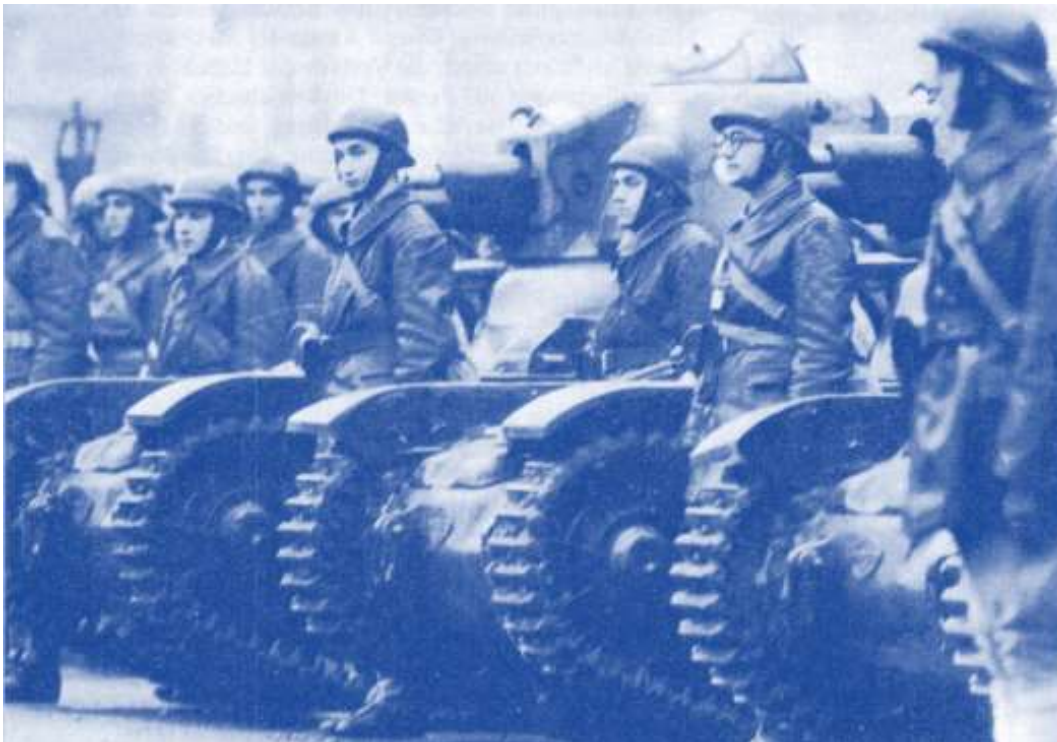
Herbst 1939: Französische Panzerereinheit mit leichten Kampfpanzern vom Typ Hotchkiss H-39. Ihr grösster Nachteil: Der Kommandant ist zugleich Richt- und Ladeschütze
