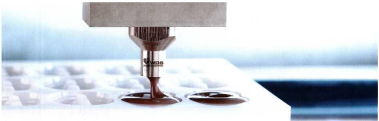
Dosieren in Pralinen beim One-Shot-Verfahren Winkler und Dünneber Süsswarenmaschinen
