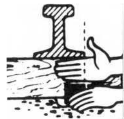
«Plaziere die Ladung 8 c tief und abschliessend mit äusseren Schienenkante»
