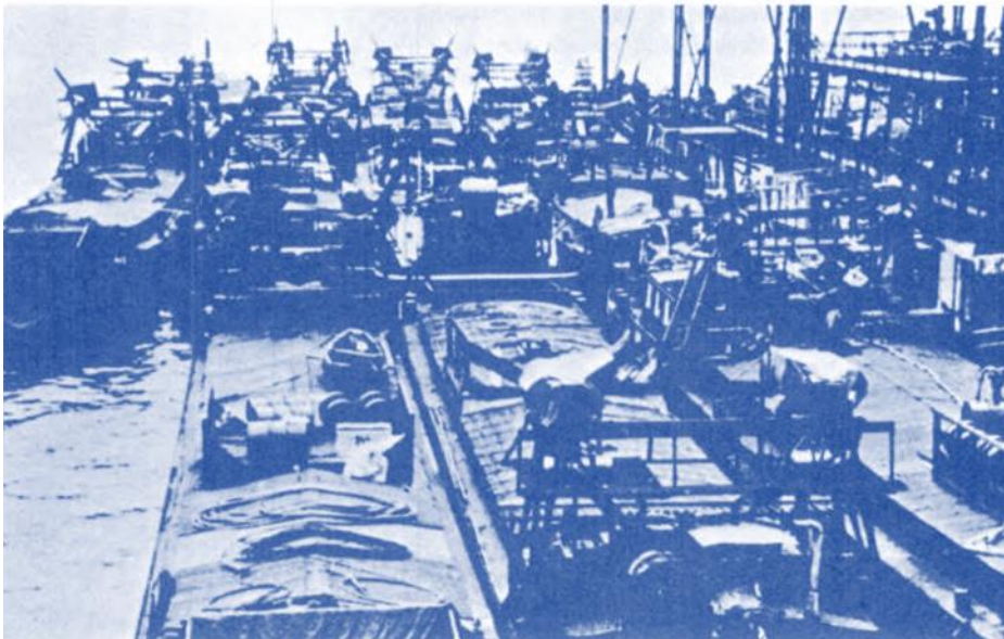
Zu Landungsfahrzeugen umgebaute Rheinkähne in einem Hafen an der Küste des Pas de Calais
