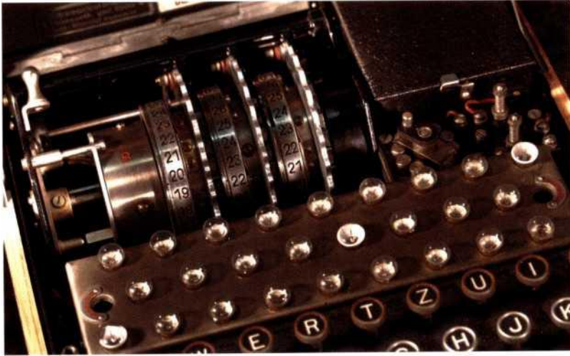
Das Innere der Enigma: Drei-Walzen-System, Tastatur und Steckerfeld.
