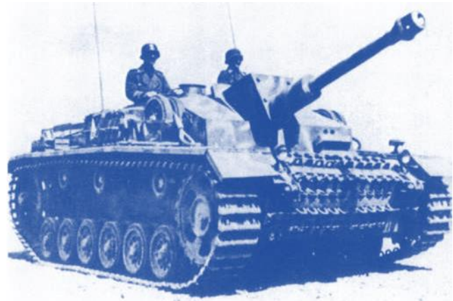
Das neue Sturmgeschütz Ausführung F mit 7,5 cm Langrohr. Endlich eine Bewaffnung die dem russischen T34 ebenbürtig ist.
