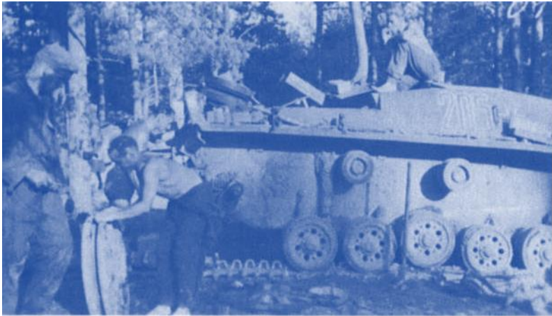
Ketten- und Laufwerkreparatur bei der 1./201.
