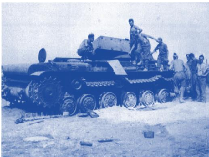
Diesen schweren KW-I-B hat es doch noch erwischt, explodierende Bereitschaftsmunition hat den Turm abgerissen und seitlich wegrutschen lassen.
