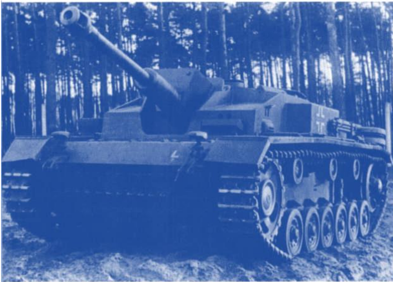
Das Sturmgeschütz mit der 7,5 cm Stu.K. L/48.
