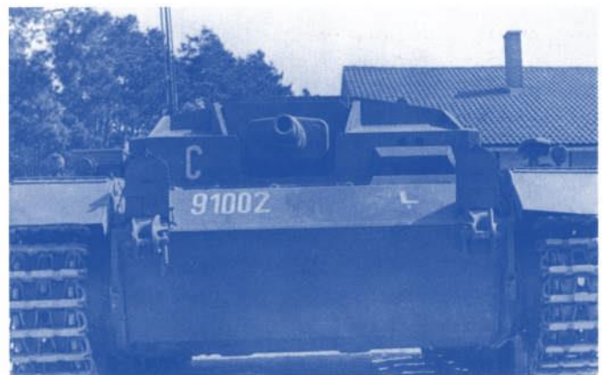
Das «Gesicht» eines Sturmgeschützes, hier ein Kurzrohr mit 7,5 cm L24.
