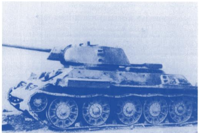
Der russische T34/76, ein gefährlicher Panzer der in grossen Stückzahlen auftrat. Hier die Ausführung von 1941 mit Ganzstahl-Laufrollen.
