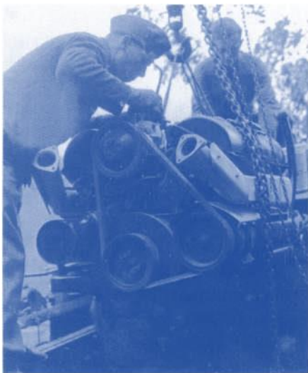
Feldinstandsetzung eines Sturmgeschützmotors.
