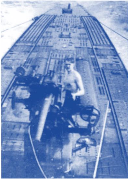
Instandsetzungsarbeiten am 3,7 cm-Flakgeschütz von U 156.
