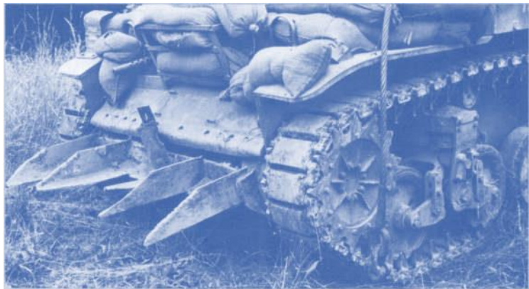
Die leichten Panzer konnten mit ihren Stahlmessern Hecken durchschneiden.
