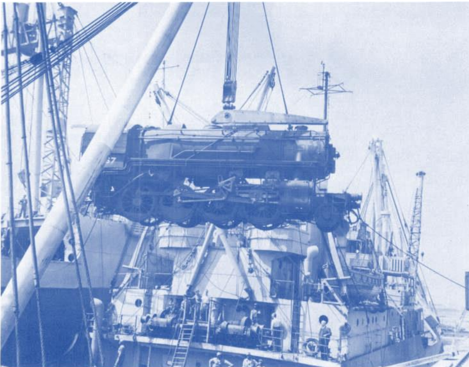
Knapp einen Monat nach Beginn der Bergungsarbeiten wird eine Lokomotive von dem Trajekt «Texas» von einem längsseits liegenden Kranschiff an Land gehievt. Leichtere Eisenbahnwaggons liess man direkt auf die Gleise rollen.
