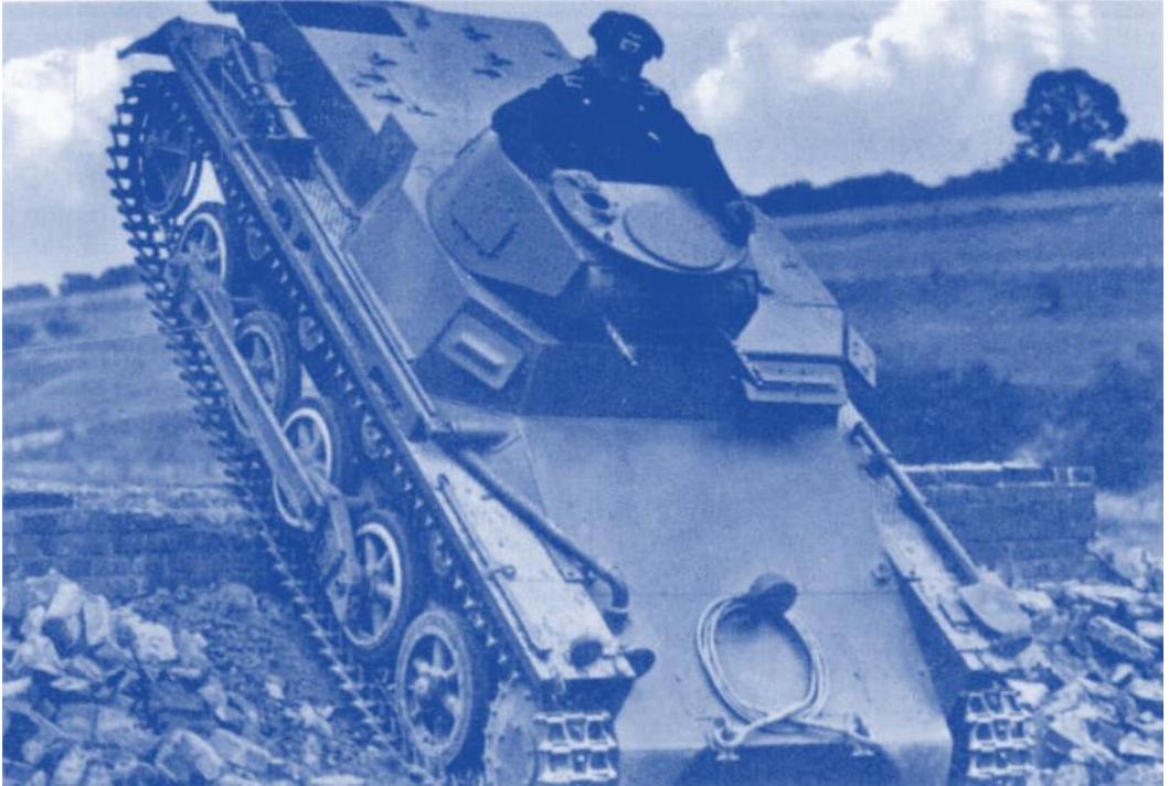
Im Jahr 1940 wurde Kurt Knispel auf einem solchen Panzer I (2 MGs/5,8 Tonnen) ausgebildet. 1944 fuhr er im Tiger II mit 68 Tonnen, von dem eine Marschkette fast soviel wog, wie der ganze Panzer I von 1940!
