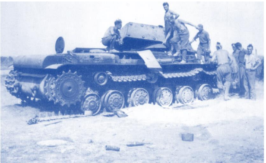
Durch die Detonation seiner Bereitschaftsmunition wurde diesem KW-1 C die Panzerkuppel angehoben.
