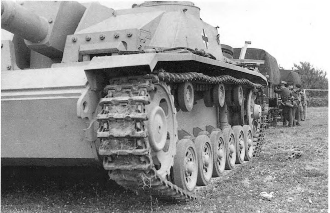
Mit den Sturmgeschützen in Epaignes: Hinter den vorderen Antriebsrad sind die sechs Laufrollen und drei Stützrollen der Panzerkette sowie an der Frontpartie die Schrauben für eine zusätzliche Panzerplatte zu erkennen.
