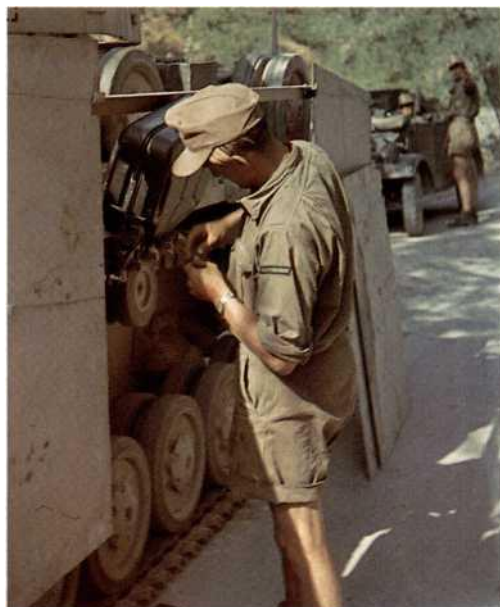
Doppeltes Auftanken: Zum Auftanken sind zwei Panzerschürzen abgenommen und ein 20-l-Kanister zwischen Kette und Metallgestell geklemmt. Das Benzin läuft über einen Einfüllstutzen in den Tank. Gleichzeitig füllt der Unteroffizier.
