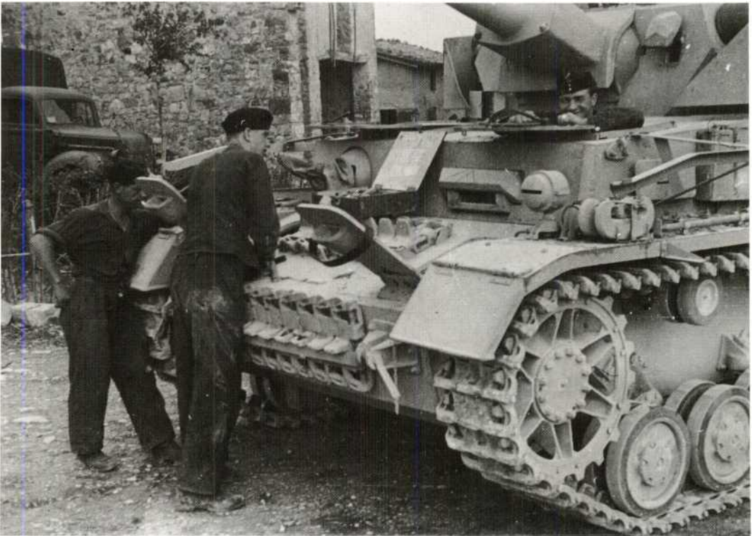
Zu schnell gefahren und heftig gebremst: Der Instandsetzungsstrupp muss die Lenkbremsen reparieren, hierfür sind die Bremsklappen geöffnet.
