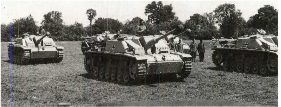
Mit den Sturmgeschützen in Epaignes: Sturmgeschütz III G mit 7,5-cm-Kanone (L 48). Das vordere Sturmgeschütz hat eine zusätzliche Panzerung am Bug des Fahrgestells und eine Nebelwurfanlage (über der ersten Stützrolle)
