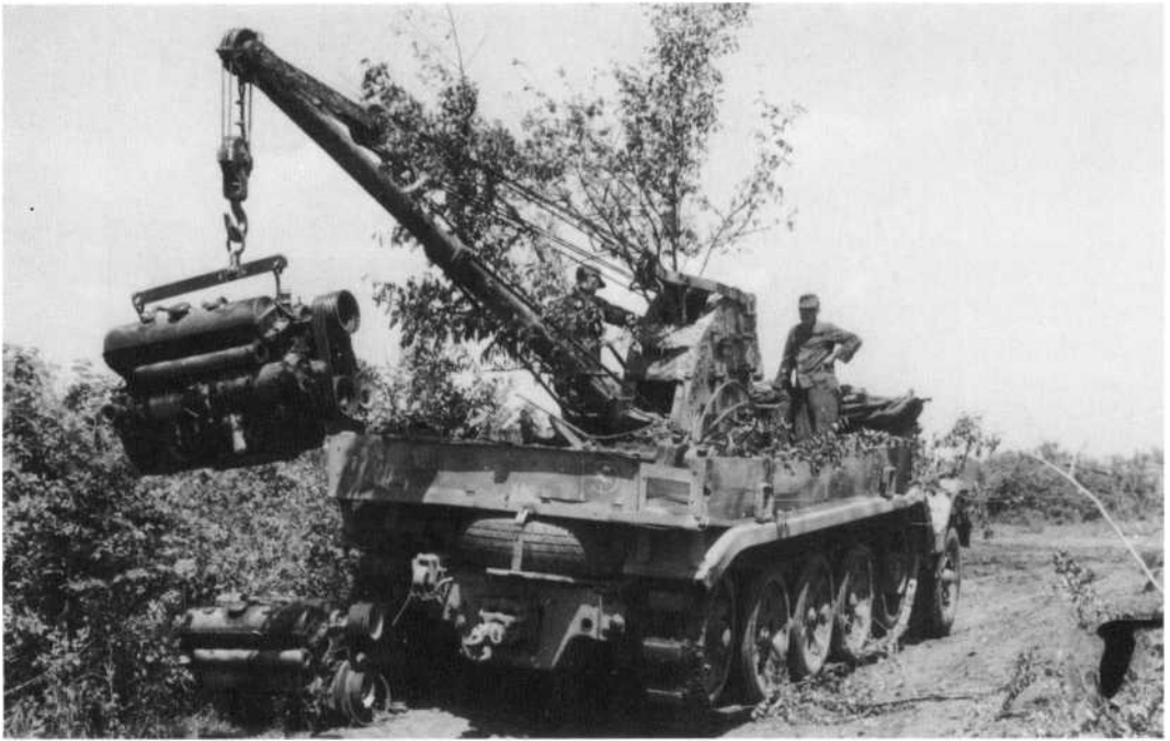
Motortausch: Ein stets ersehnter Augenblick der Ruhe hinter der Front. Austausch des Motors am 12.04. 1944. Am Kran der Zugmaschine der neue Maybachmotor – Ölkühler- und Lichtmaschinen-seite Motor am Kran: Der neue Motor wird eingebaut.
