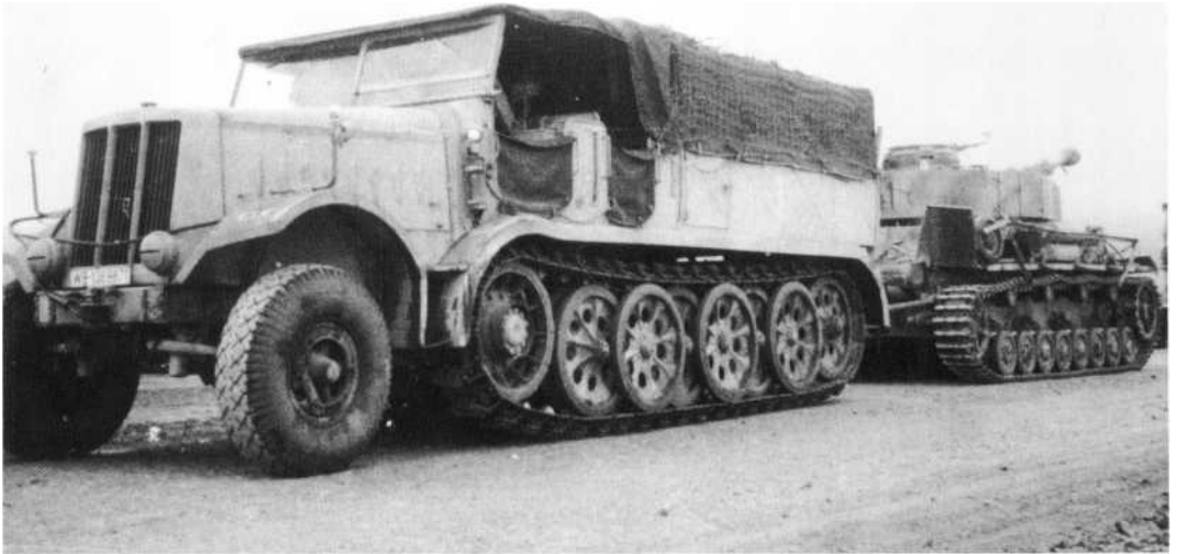
Vor der Fahrt in die Etappenstadt Kirowograd: Pz. 1241 wird von einer 18-t-Zugmaschine abgeschleppt (rückwärts, da eine vordere Abschleppöse am Panzer abgebrochen war). Die Zugmaschine (Famo Typ F 3) war ein besonderer benzinfresser.
