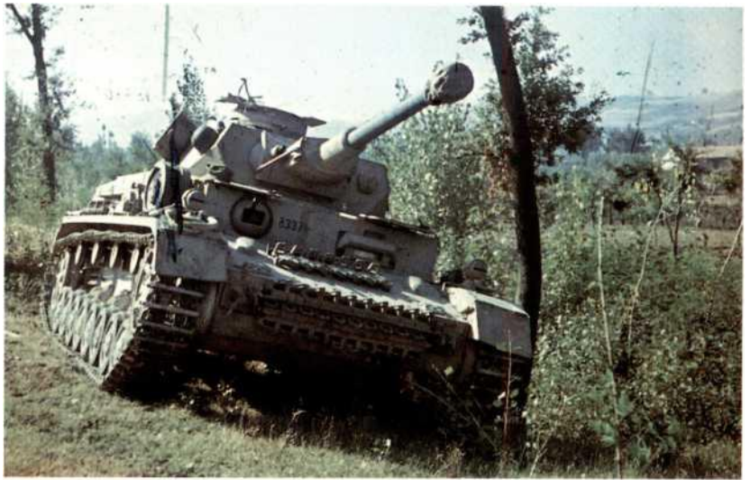
Panzer IV (Ausf. G) ohne Schürze: Am Bugpanzer sind zusätzliche Kettenglieder befestigt. An der Stirnwand links die Kugelblende mit MG 34 des Funkers. Die Lampen auf den Abdeckblechen haben Schlitzblenden.
