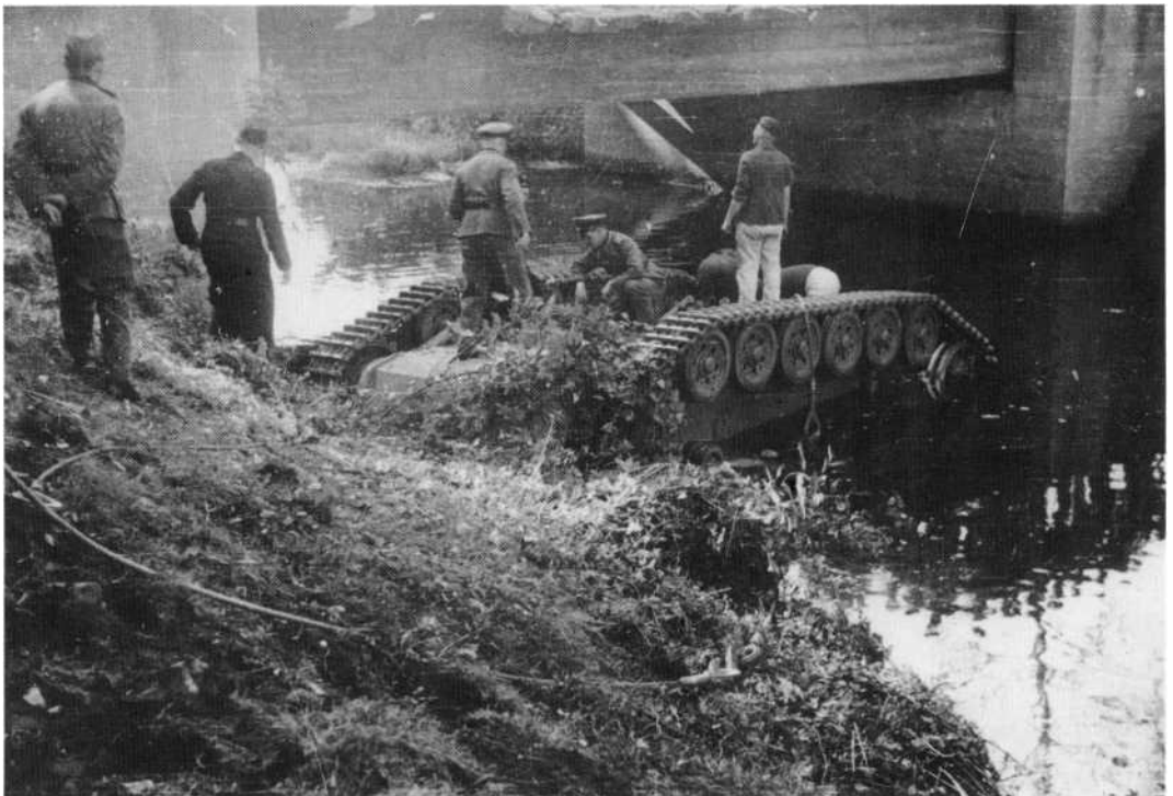
Mit dem «Kopf» im Wasser: Nach dem ersten Bergungsversuch liegt der Panzer jetzt auf dem Turm im Wasser. Mit den Abschleppseilen wird er anschliessend von einer Reihe anderer Panzer umgekippt und herausgezogen.
