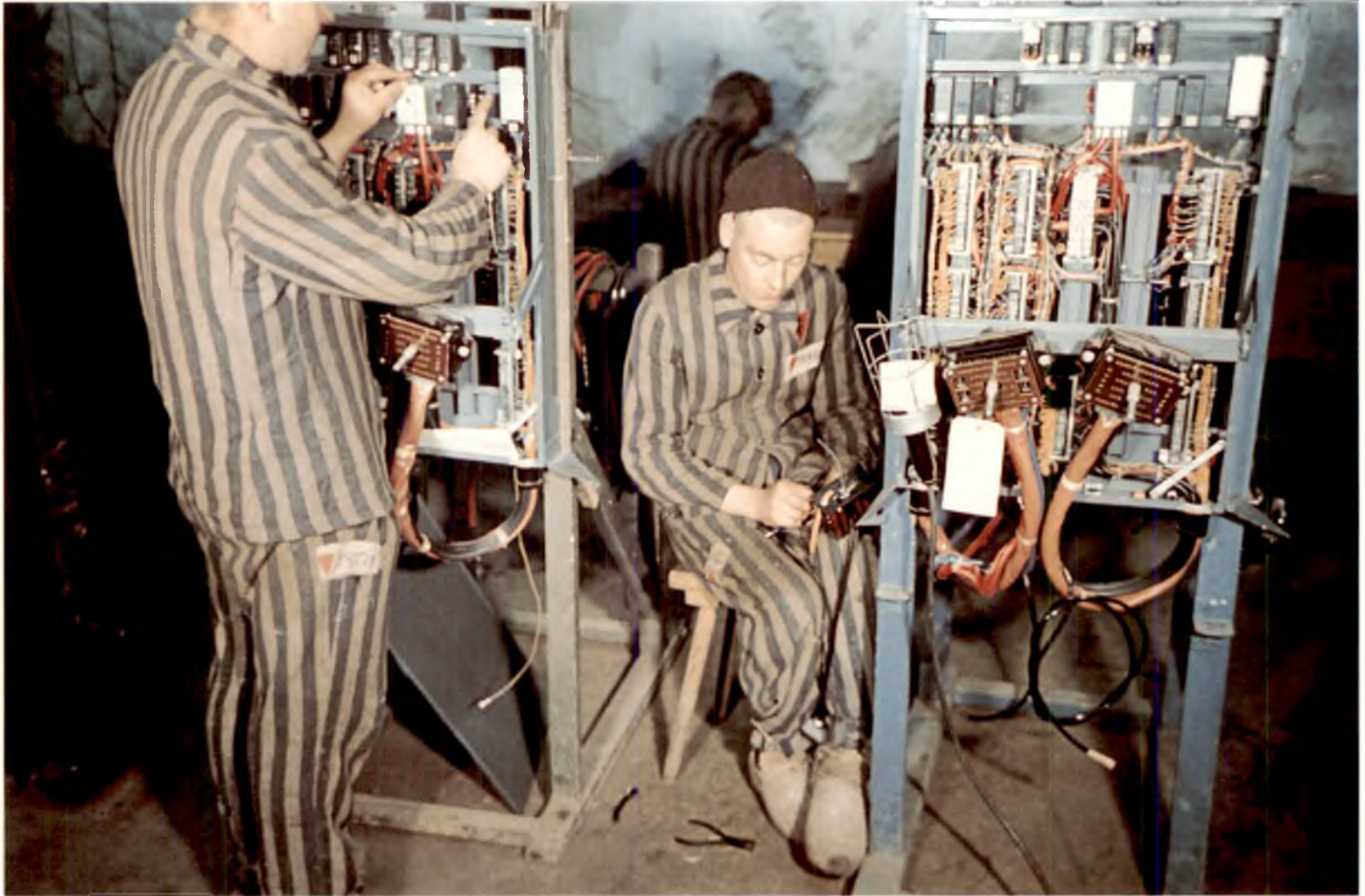
86. Walter Frenz, montage des fusées V2 à Dora, deux détenus travaillent au câblage des connexions électriques des compartiments de guidage des fusées, mai - juillet 1944 (Ullstein Bilderdienst)
