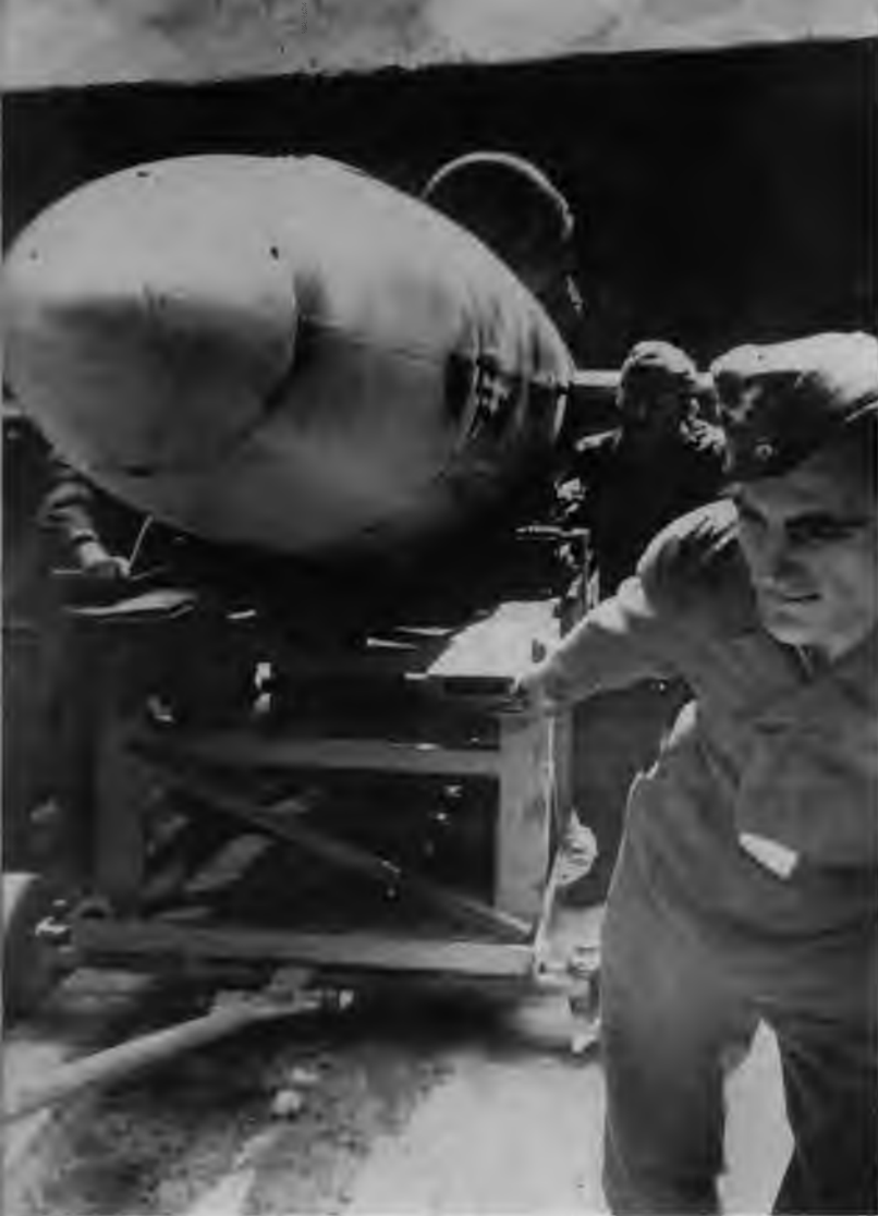
Eine V-1 wird aus guter Deckung heraus zur Abschlußrampe gerollt. Der Start erfolgte mittels einer Preßluftanlage.
