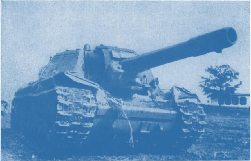
Russische Sturmartillerie. 15,2-cm-Kanone, montiert auf das Chassis eines 60-Tonnen-Tanks, Typ Klim Woroschilow .
